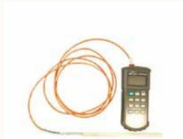
**Thermomètre + sonde type S (1 400 °C)**
