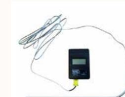
**Thermomètre + sonde type K (1 200 °C)**
